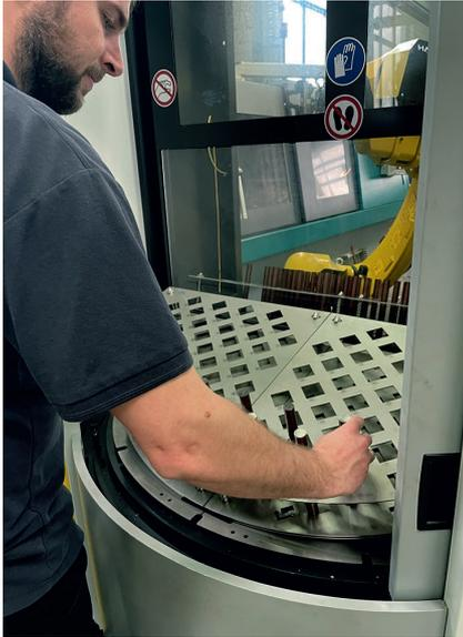
4 Während der Roboter arbeitet, können auf der Rückseite der Zelle die Fertigteile entnommen und der Materialpuffer mit neuen Rohteilen bestückt werden © Halter
