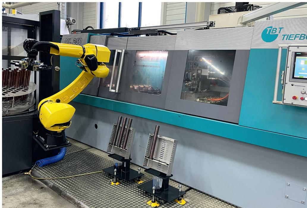
1 Seit März 2023 wird bei Ott-Jakob Spanntechnik in Lenggenwang ein eigens modifizierter Halter LoadAssistant mit einer Robotertragkraft von 35 kg für das Be- und Entladen einer Tieflochbohrmaschine eingesetzt © Halter
